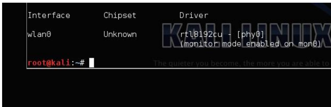
Рисунок 2 – конфигурация беспроводной карты
